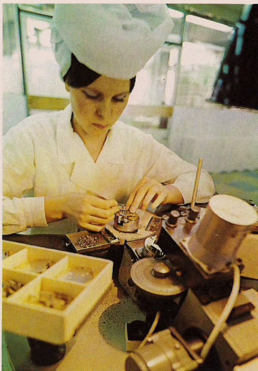
Полуавтоматы собирают узлы часовых деталей
