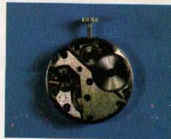
Werkkaliber 26 mm, Werkhöhe 3,98 mm, 19 Rubinsteine, Ankerhemmung, Zentrumssekunde, Stoßsicherung der Unruhwelle.
