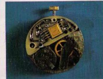
Механизм на 10 рубиновых камнях, с кварцевым генератором, приводом от шагового двигателя, с центральной секундной стрелкой, двойным календарным устройством мгновенного действия, механизмом мгновенной коррек-
