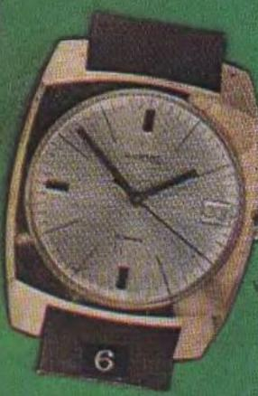
«Восток» 2214 — механизм калибра 22 мм, высотой 3,2 мм, на 18 рубиновых камнях, с анкерным спуском, центральной секундной стрелкой, противоударным устройством оси баланса, календарным устройством немгновенного действия, показывающим дату. Средний суточный ход от -25 до +65 с. Продолжительность действия от одной полной заводки пружины не менее 39 ч. Класс точности 2.
