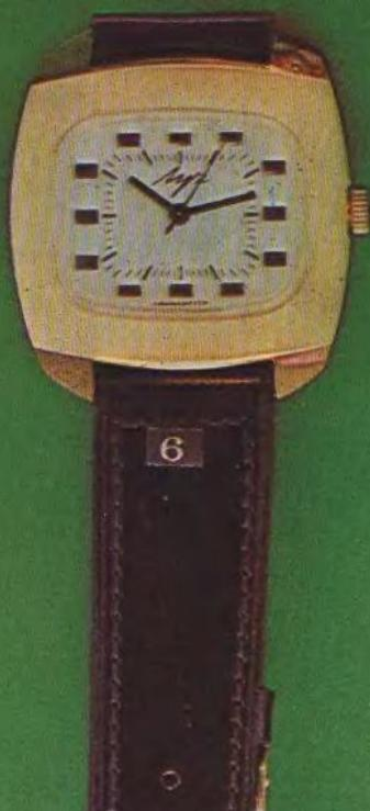
«Луч» 2209 — механизм калибра 22 мм, высотой 2,9 мм, на 23 рубиновых камнях, с анкерным спуском, центральной секундной стрелкой и противоударным устройством оси баланса. Средний суточный ход от -20 до +40 с. Продолжительность действия от одной полной заводки пружины не менее 39 ч. Класс точности I.
