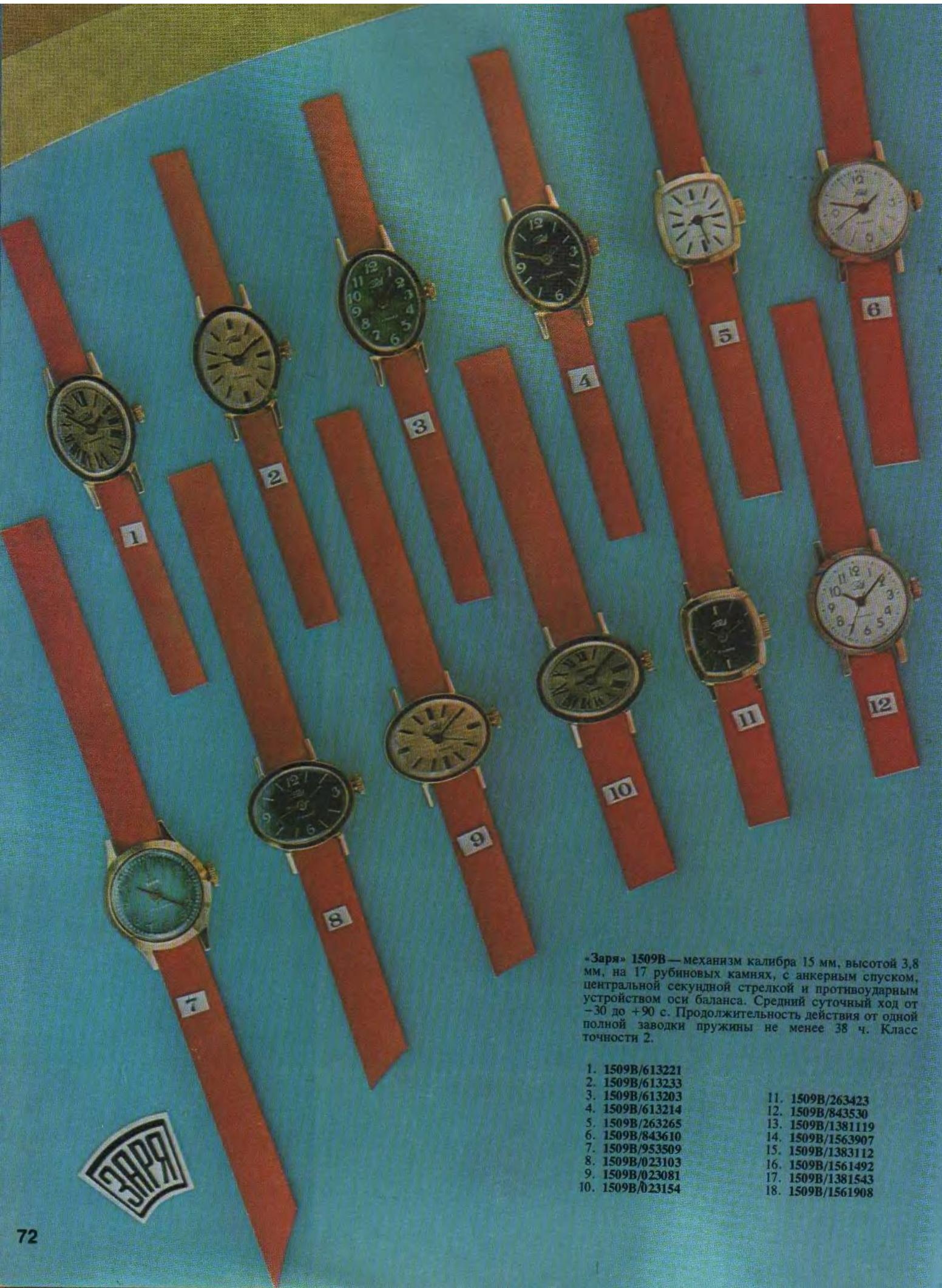
«Заря» 1509В — механизм калибра 15 мм, высотой 3,8 мм, на 17 рубиновых камнях, с анкерным спуском, центральной секундной стрелкой и противоударным устройством оси баланса. Средний суточный ход от -30 до +90 с. Продолжительность действия от одной полной заводки пружины не менее 38 ч. Класс точности 2.
