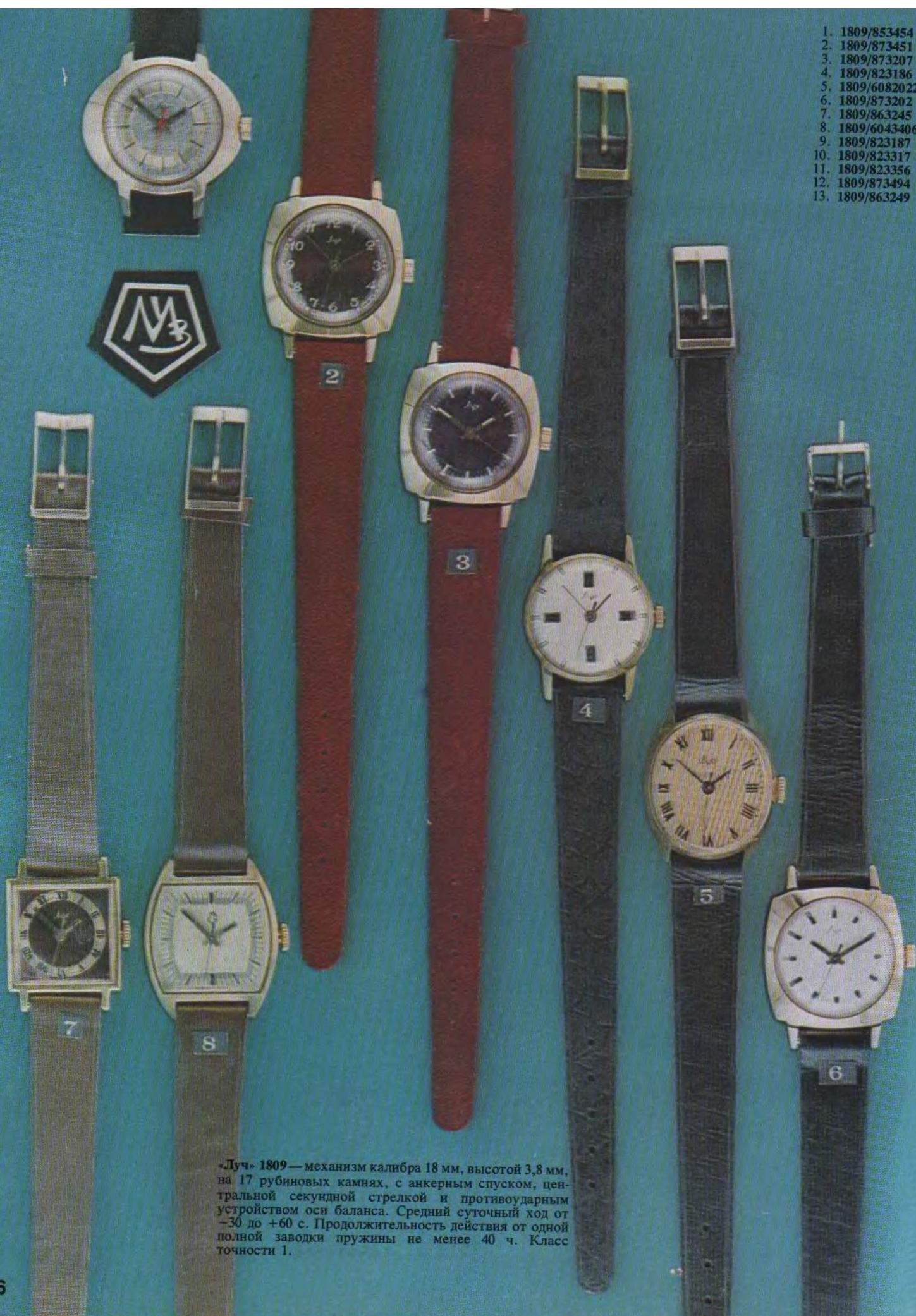
«Луч» 1809 — механизм калибра 18 мм, высотой 3,8 мм, на 17 рубиновых камнях, с анкерным спуском, центральной секундной стрелкой и противоударным устройством оси баланса. Средний суточный ход от -30 до +60 с. Продолжительность действия от одной полной заводки пружины не менее 40 ч. Класс точности 1.
