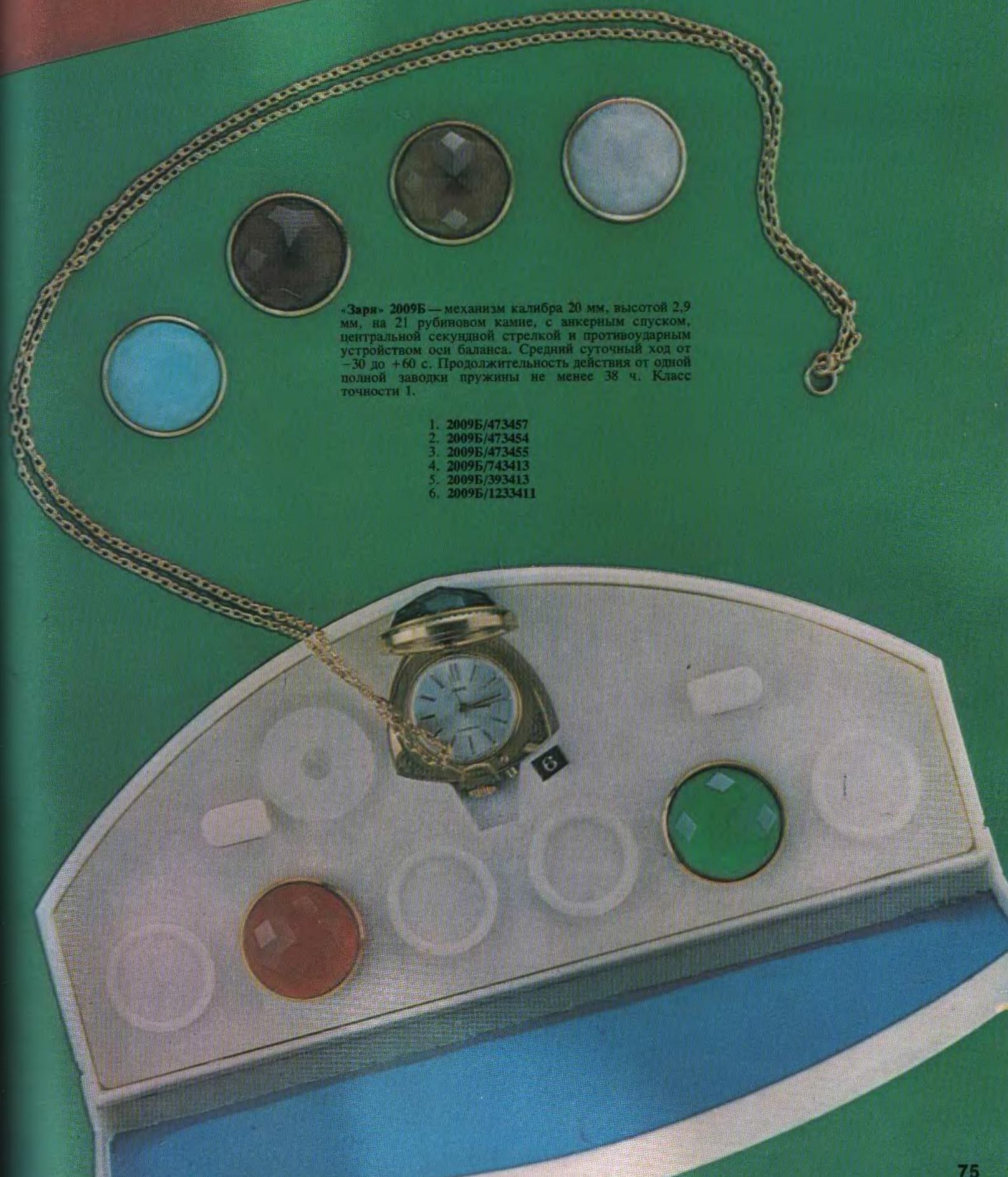
«Заря» 2009Б — механизм калибра 20 мм, высотой 2,9 мм, на 21 рубиновом камне, с анкерным спуском, центральной секундной стрелкой и противоударным устройством оси баланса. Средний суточный ход от -30 до +60 с. Продолжительность действия от одной полной заводки пружины не менее 38 ч. Класс точности 1.
