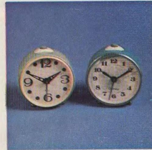
«Севани» 8973 — механизм калибра 89 мм, высотой 22,4 мм, на 4 рубиновых камнях, с анкерным штифтовым спуском и центральной сигнальной стрелкой. Средний суточный ход  $\pm 120$  с. Периодичность заводки один раз в сутки. Класс точности 2.
