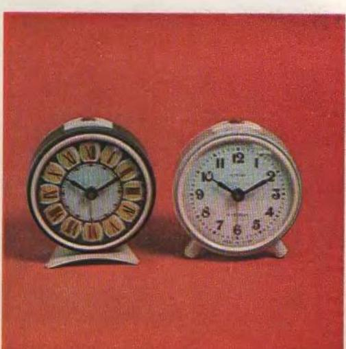
**«Витязь» 6373** — механизм калибра 63 мм, высотой 22 мм, на 4 рубиновых камнях, с анкерным штифтовым спуском, центральной сигнальной стрелкой. Средний суточный ход  $\pm 150$  с. Периодичность заводки один раз в сутки.
