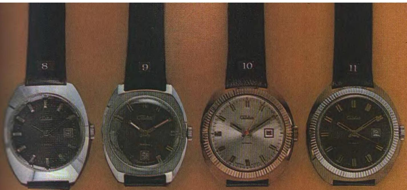
«Слава» 2414 — механизм калибра 24 мм, высотой 3,8 мм, на 21 рубиновом камне, с анкерным спуском, центральной секундной стрелкой, противоударным устройством оси баланса, календарным устройством мгновенного действия. Средний суточный ход от одной полной заводки пружины не менее 45 ч. Класс точности 1.
