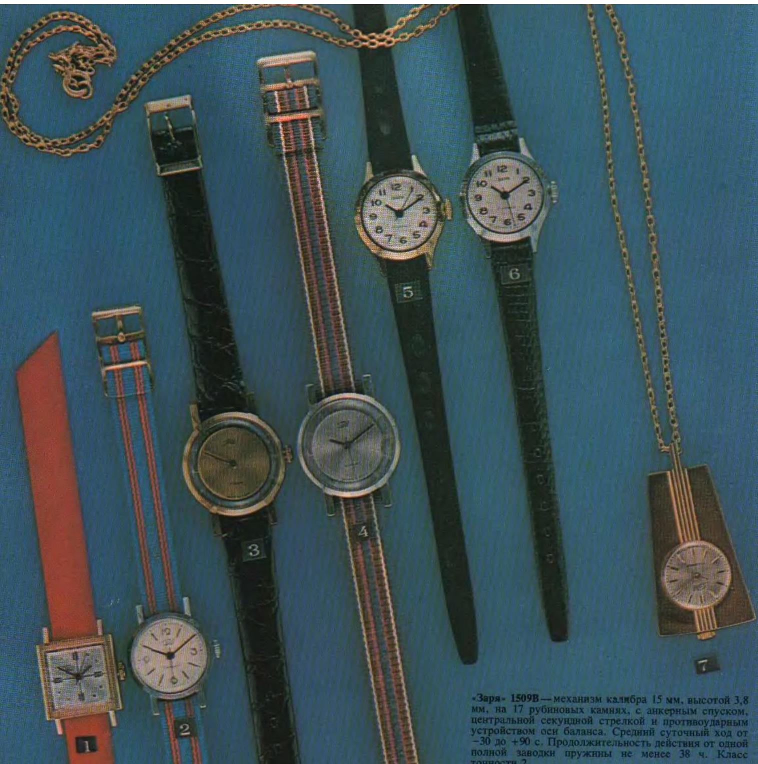
«Заря» 1509В — механизм калибра 15 мм, высотой 3,8 мм, на 17 рубиновых камнях, с анкерным спуском, центральной секундной стрелкой и противоударным устройством оси баланса. Средний суточный ход от -30 до +90 с. Продолжительность действия от одной полной заводки пружины не менее 38 ч. Класс точности 2.
