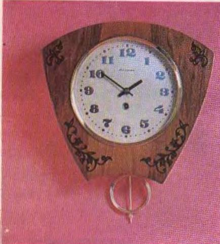
«Янтарь» 118151 — механизм маятниковый с площадью платины 11000 мм<sup>2</sup>, высотой 40 мм, возвратно-крючковым спуском, боем часов и получасов. Средний суточный ход не более 10 мин за две недели. Продолжительность действия от одной полной заводки пружины не менее 16 суток.
