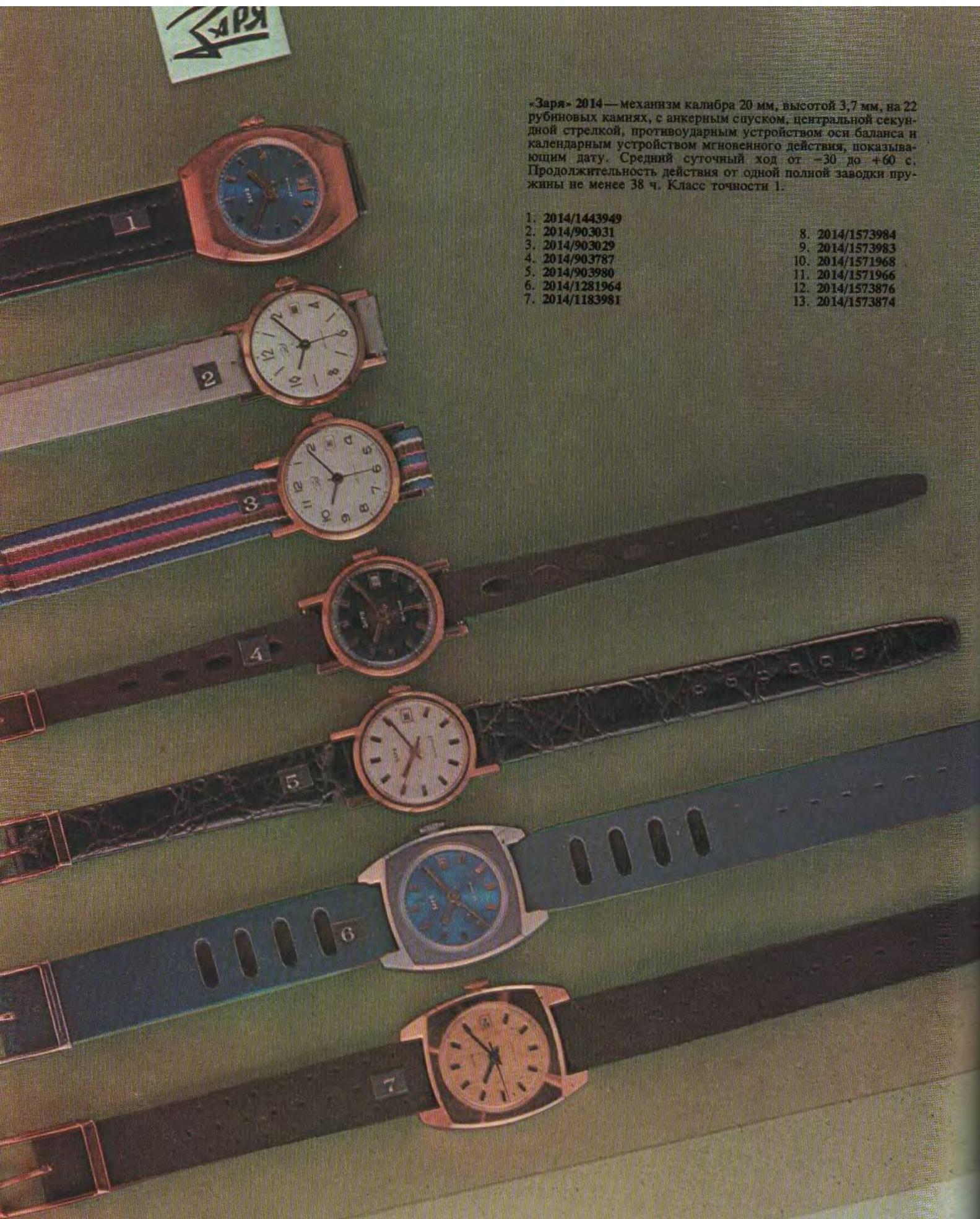
«Заря» 2014 — механизм калибра 20 мм, высотой 3,7 мм, на 22 рубиновых камнях, с анкерным спуском, центральной секундной стрелкой, противоударным устройством оси баланса и календарным устройством мгновенного действия, показывающим дату. Средний суточный ход от -30 до +60 с. Продолжительность действия от одной полной заводки пружины не менее 38 ч. Класс точности 1.
