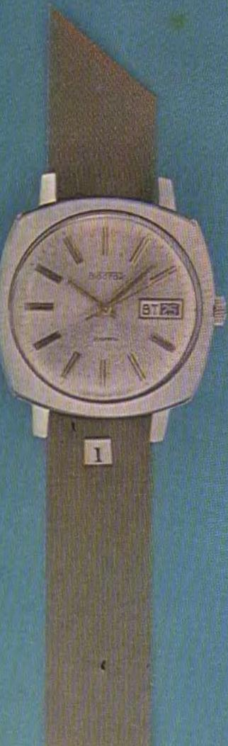
«Восток» 2427 — механизм калибра 24 мм, высотой 5,95 мм, на 21 рубиновом камне, с анкерным спуском, центральной секундной стрелкой, противоударным устройством оси баланса, автоподзаводом и календарным устройством, показывающим дату и день недели. Средний суточный ход от -20 до +40 с. Продолжительность действия от одной полной заводки пружины не менее 41 ч. Класс точности 1.
