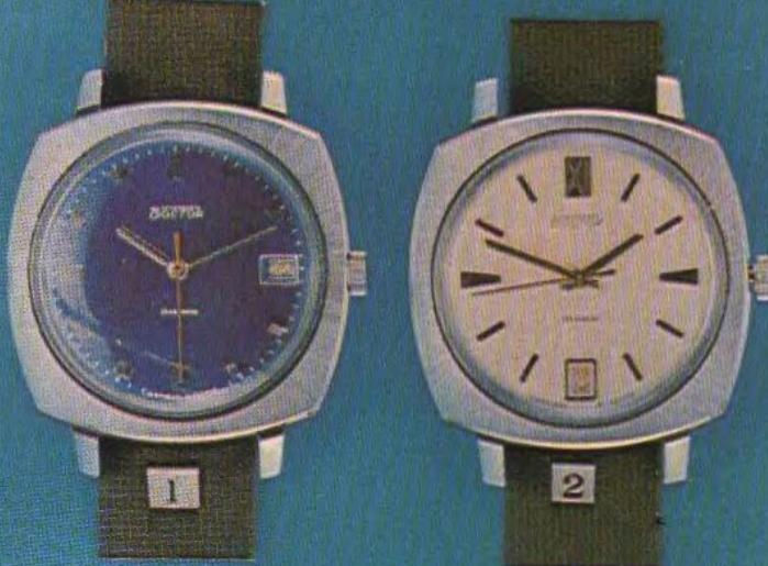
«Восток» 2416 — механизм калибра 24 мм, высотой 5,2 мм, на 21 рубиновом камне, с анкерным спуском, центральной секундной стрелкой, противоударным устройством оси баланса, автоподзаводом, календарным устройством, показывающим дату. Средний суточный ход от -20 до +40 с. Продолжительность от одной полной заводки пружины не менее 41 ч. Класс точности 1.
