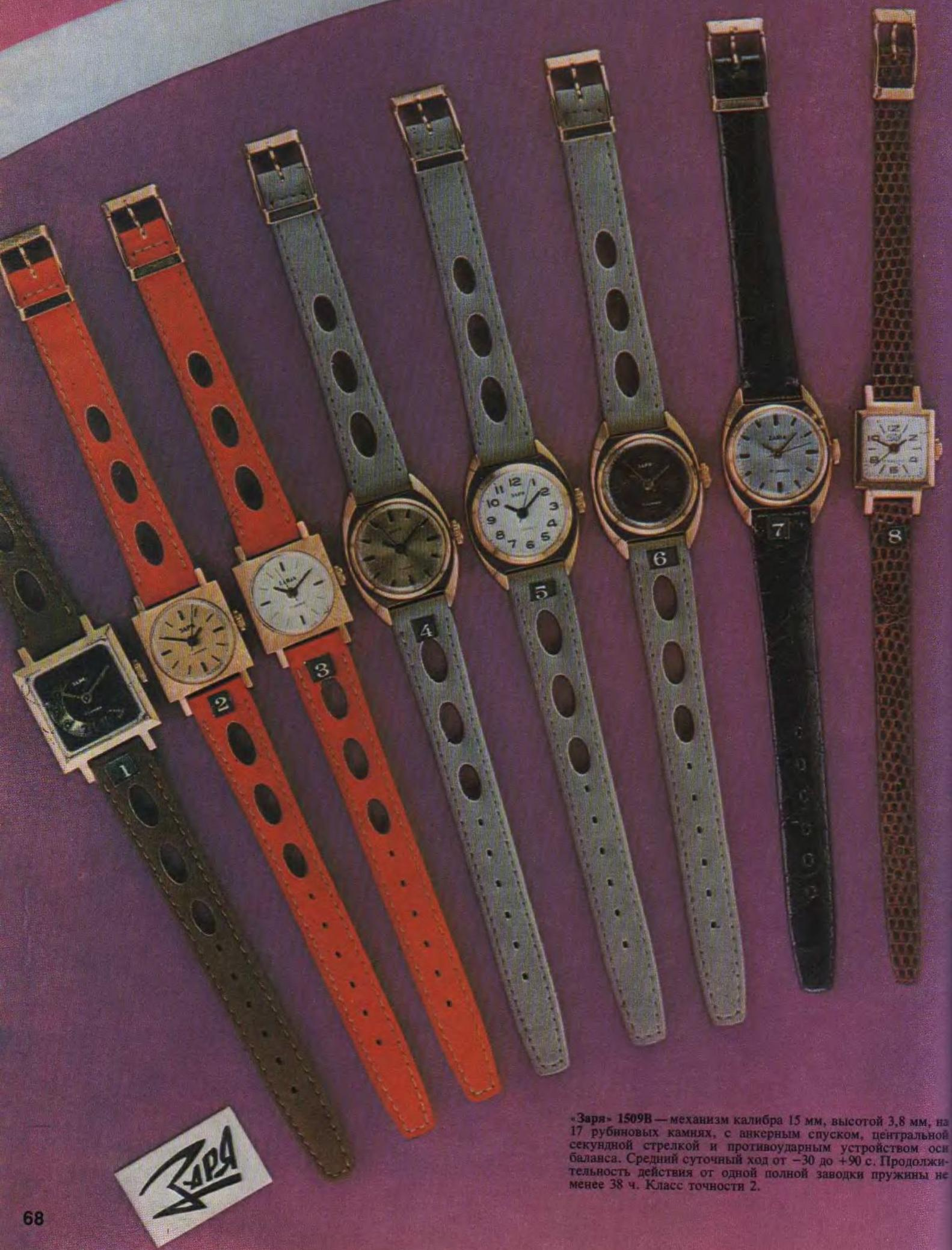
«Заря» 1509В — механизм калибра 15 мм, высотой 3,8 мм, на 17 рубиновых камнях, с анкерным спуском, центральной секундной стрелкой и противоударным устройством оси баланса. Средний суточный ход от -30 до +90 с. Продолжительность действия от одной полной заводки пружины не менее 38 ч. Класс точности 2.
