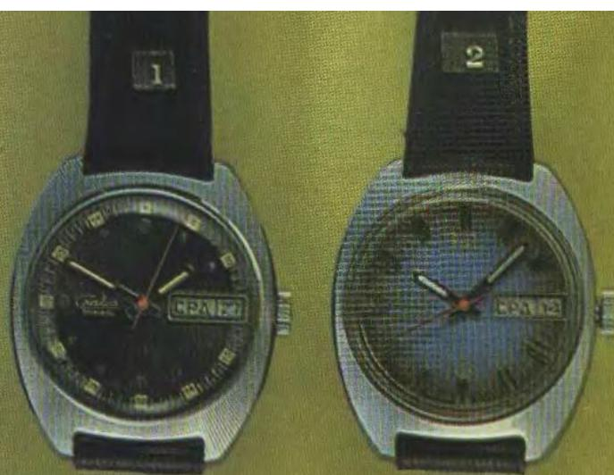
«Слава» 2427 — механизм калибра 24 мм, высотой 6,8 мм, на 31 рубиновом камне, с анкерным спуском, центральной секундной стрелкой, противоударным устройством оси баланса, автоматическим подзаводом, двойным календарем с мгновенной сменой чисел месяца и немгновенной сменой дней недели. Средний суточный ход от -20 до +40 с. Класс точности I.
