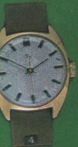
«Свет» 2609 НА — механизм калибра 26 мм, высотой 3,9 мм, на 19 рубиновых камнях, с анкерным спуском, центральной секундной стрелкой и противоударным устройством оси баланса. Средний суточный ход от -20 до +40 с. Продолжительность действия от одной полной заводки не менее 42 ч. Класс точности 1.
