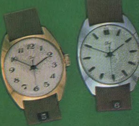
«Свет» 2609 — механизм калибра 26 мм, высотой 4,5 мм, на 16 рубиновых камнях, с анкерным спуском, центральной секундной стрелкой и противоударным устройством оси баланса. Средний суточный ход от -25 до +65 с. Продолжительность действия от одной полной заводки не менее 36 ч. Класс точности 2.
