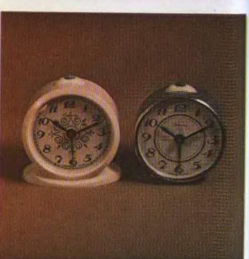
«Севани» 8973 — механизм калибра 89 мм, высотой 22,4 мм, на 4 рубиновых камнях, с анкерным штифтовым спуском и центральной сигнальной стрелкой. Средний суточный ход  $\pm 120$  с. Периодичность заводки один раз в сутки. Класс точности 2.
