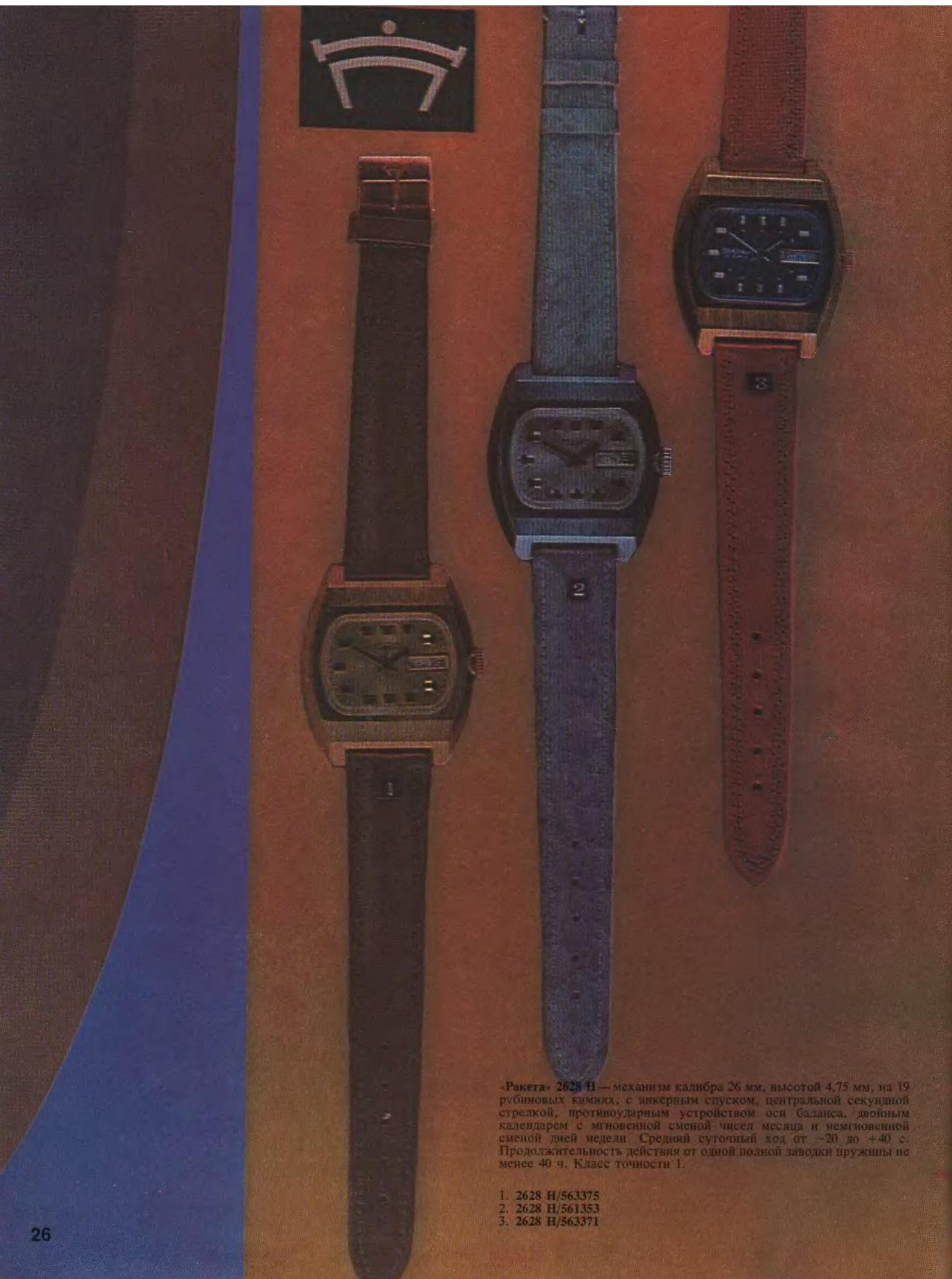
«Ракета» 2628 Н — механизм калибра 26 мм, высотой 4,75 мм, на 19 рубиновых камнях, с анкерным спуском, центральной секундной стрелкой, противоударным устройством оси баланса, двойным календарем с мгновенной сменой чисел месяца и немгновенной сменой дней недели. Средний суточный ход от -20 до +40 с. Продолжительность действия от одной полной заводки пружины не менее 40 ч. Класс точности I.
