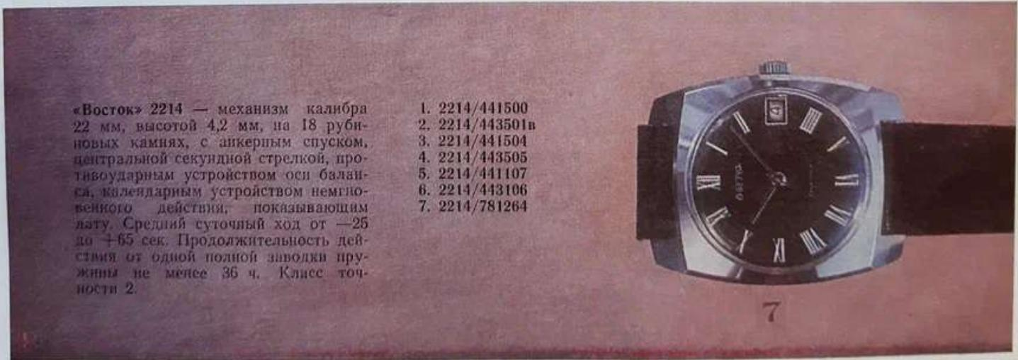
«Восток» 2214 — механизм калибра 22 мм, высотой 4,2 мм, на 18 рубиновых камнях, с анкерным спуском, центральной секундной стрелкой, противовударным устройством оси баланса, календарным устройством немигновенного действия, показывающим лату. Средний суточный ход от —26 до +65 сек. Продолжительность действия от одной полной заводки пружины не менее 36 ч. Класс точности 2.
