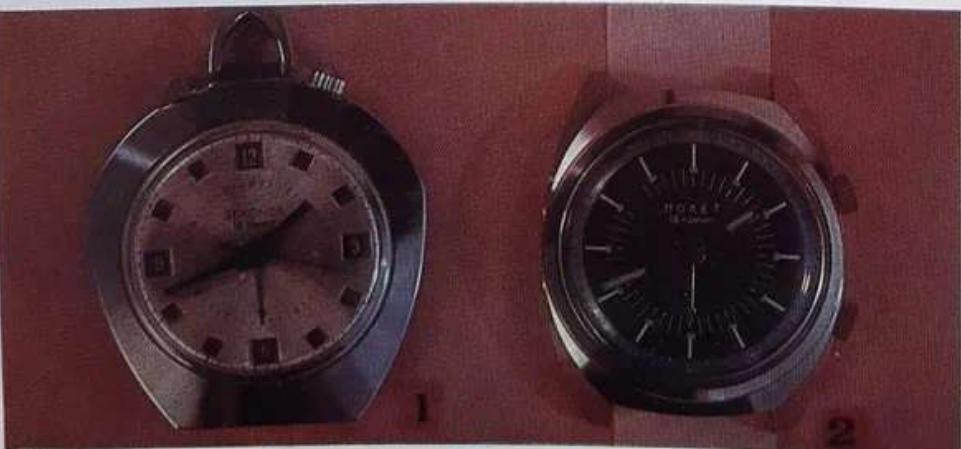
«Полет» 2612 — механизм калибра 26 мм, высотой 5,8 мм, из 18 рубиновых камнях, с анкерным спуском, центральной секундной стрелкой, противоударным устройством оси баланса и сигнальным устройством. Средний суточный ход от -25 до +65 сек. Продолжительность действия от одной полной заводки пружины не менее 36 ч. Класс точности II.
